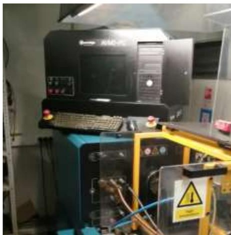
**Диагностический прибор для проверки форсунок электронный HARTRIDGE «Тестмастер НН700», тип НН700.01 №53916, 2000 года выпуска.**
